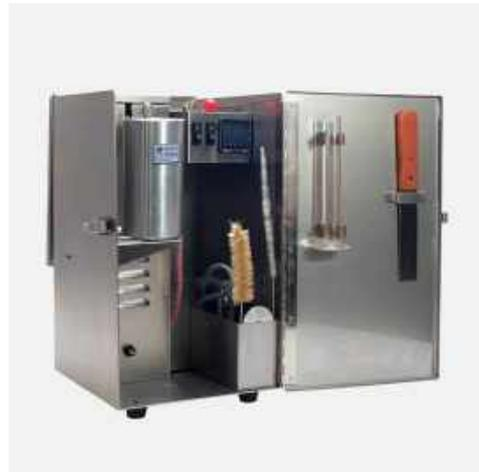
钻井液油水固相分离装置
