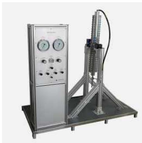
高压可视封堵试验仪
