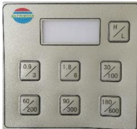
(图三) HTD13185 型旋转粘度计控制面板
