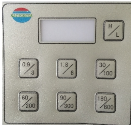
(图三) HTD13185 型旋转粘度计控制面板
